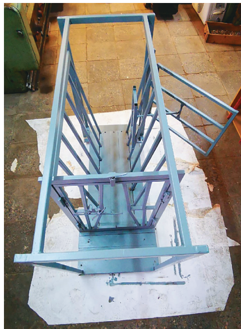
Рис. 1. Поворотный станок для искусственного осеменения овец
